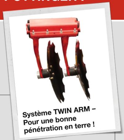
Le système TWIN ARM est constitué de deux bras porte-disques montés sur une seule bride large. Les disques ne peuvent plus subir aucun déplacement latéral. Grâce au montage sur boudins caoutchouc et aux paliers de disques lubrifiés par bain d'huile, le dispositif est totalement sans entretien.
