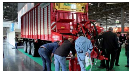
Viacúčelový zberací voz Jumbo 10010 Combiline s objemom 100 m 3 je možné použiť ako zberací voz s rezaním pre zber senáže a aj ako dopravný prostriedok na odvoz kukurice od rezačky.
