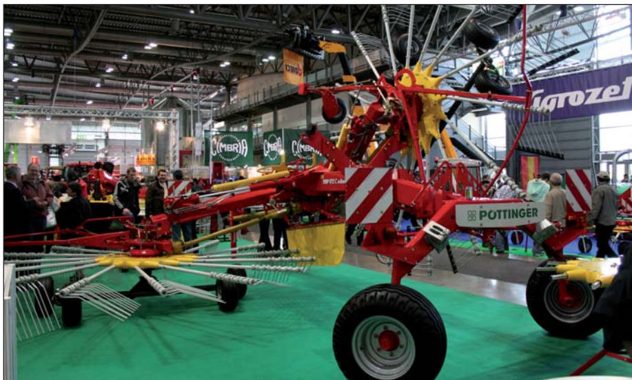
Stredový zhrňovač Top 972 C s-line. Až sedem kopírovacích koliesok spolu s nezávislým zavesením rotorov zaručujú presné vedenie prstov.
