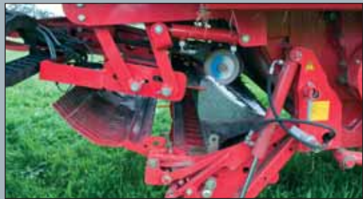
Vyššia kvalita zberu, nižšia spotreba, vyššia výkonnosť. To sú hlavné výhody automatickej brúsky nožov AutoCut na vozoch Jumbo 10010.
