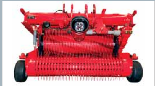
Zberač s 8-mi radmi prstov, kopírovacie kolesá, vkladacie ústrojenstvo s 8 radmi hviezdíc, usporiadanými do špirály zabezpečujú plynulý a bezstratový zber z riadku širokého max. 2 m.
