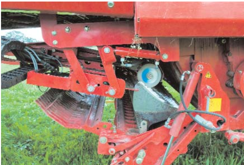
Plně automatické zařízení na broušení nožů autocut vozů Jumbo
