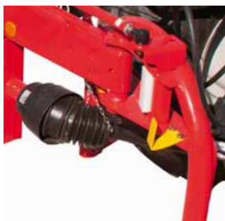
Indicateur d'angle de braquage sur la tête d'attelage
