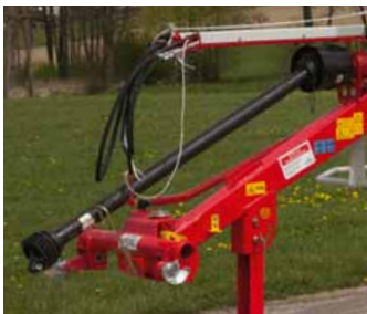
Un support de dépose du cardan et des flexibles est fourni en standard.
